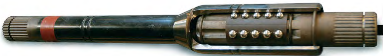
Рисунок 1.13 – Телескопический карданный вал фирмы GKN Driveline для автомобилей Volvo [AP.05.21]
