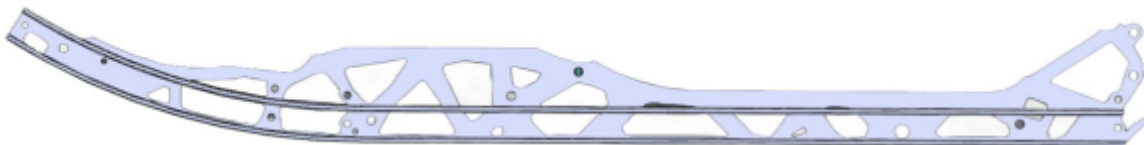
Рис. 7. Топологически оптимизированная направляющей рельсы гусеницы снегохода Фронтьер 1000
